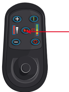
Abbildung 11: Taste „Hupe“ auf dem Bedienmodul“
