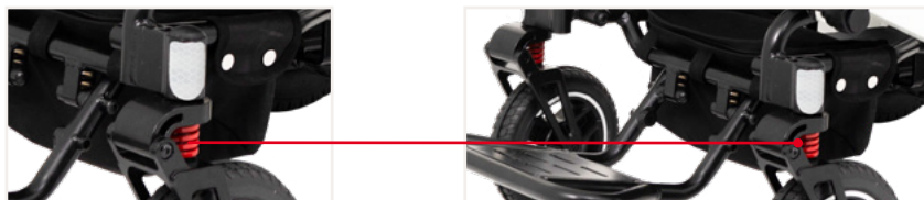
Abbildung 4: Die Federung an der Vorderradgabel des ergoflix
