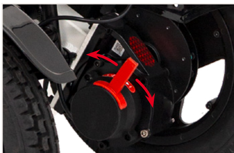
Abbildung 14: Aktivieren oder Deaktivieren der Feststellbremsen
