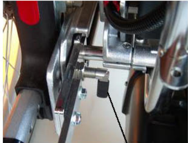
Bild 8: Hebel v. linkem Sicherungsbolzen unten, geschlossen
