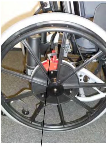
Bild 2 Rastbolzen eingerastet, Fahrbetrieb
