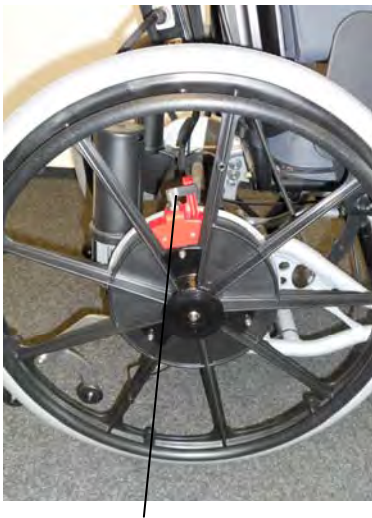
Bild 2 Rastbolzen eingerastet, Fahrbetrieb
