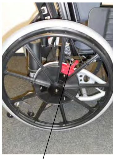
Bild 3 Rastbolzen entriegelt, Schiebebetrieb
