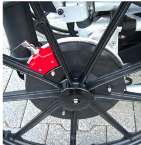
Bild 13 Bolzen bündig; Rad richtig angebaut
