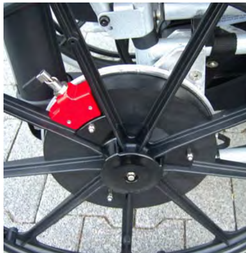
Bild 13 Bolzen bündig; Rad richtig angebaut
